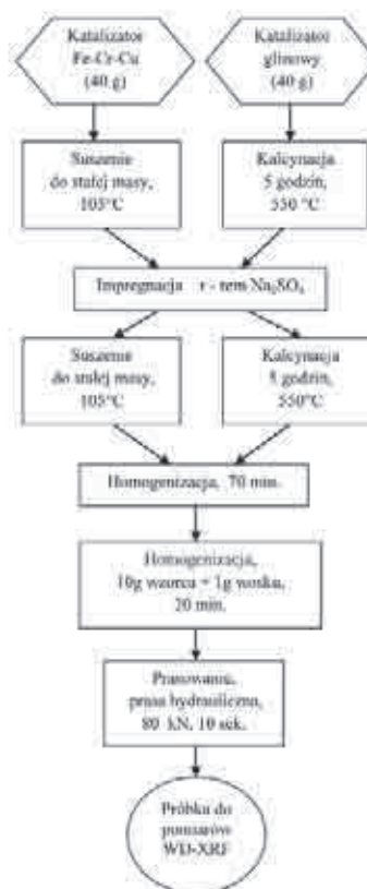
Rys. 3. Schemat przedstawiający preparatykę wzorców siarki w katalizatorze Fe-Cr-Cu i katalizatorze glinowym
