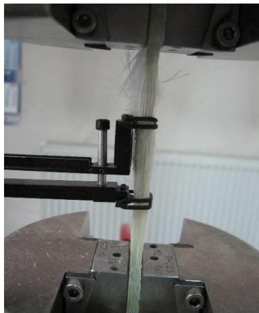
Rys. 9. Próbkę nr 5 (10 warstw zbrojenia) z kompozytu CD600 w końcowym etapie próby rozciągania
