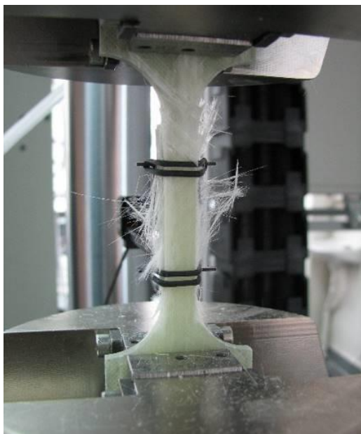
Rys. 9. Próbkę nr 5 (10 warstw zbrojenia) z kompozytu CD600 w końcowym etapie próby rozciągania
