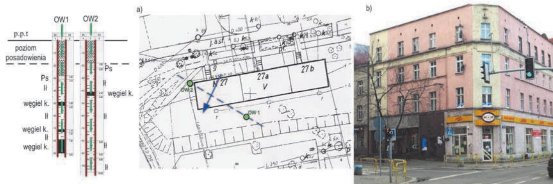
Rys. 2. a) Specyficzne przewarstwienia podłoża gruntowego w rejonie eksploatacji górnicyz; b) Kamienica z obszaru Bytomia
