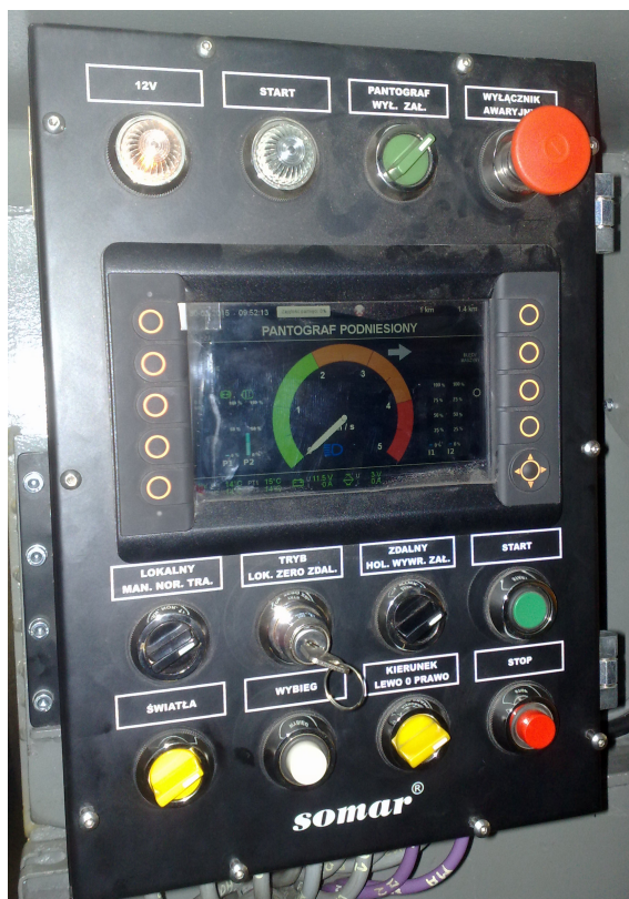
Rys. 7. Pulpit sterowniczy lokomotywy [2]
