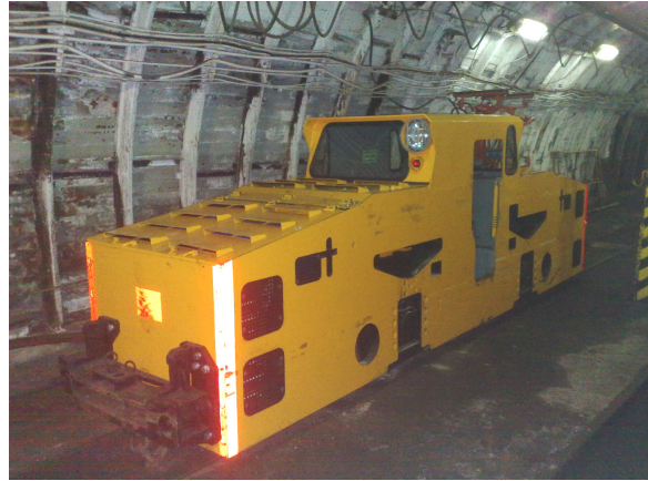
Rys. 2. Druga wersja lokomotywy Ld-31EM w KWK „Piaś” [2]
