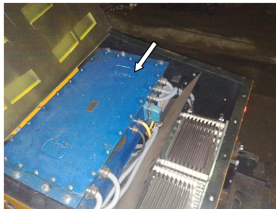
Rys. 5. Moduł przetwornika energoelektronicznego [2]
