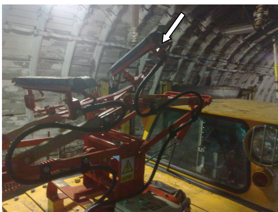
Rys. 8. Uszkodzenie odbieraka prądu [2]
