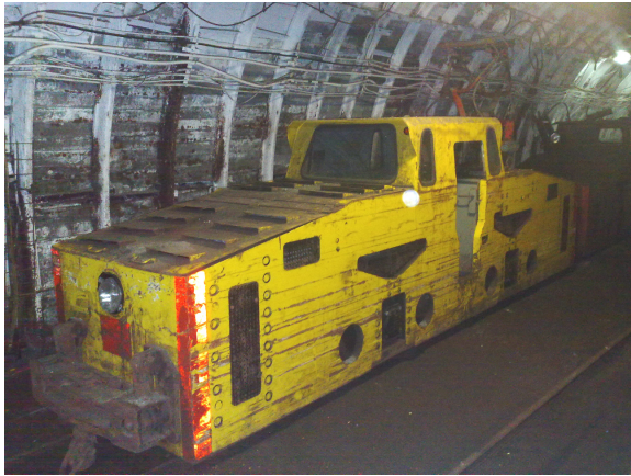
Rys. 1. Pierwsza wersja lokomotywy Ld-31EM w KWK „Piaś” [2]
