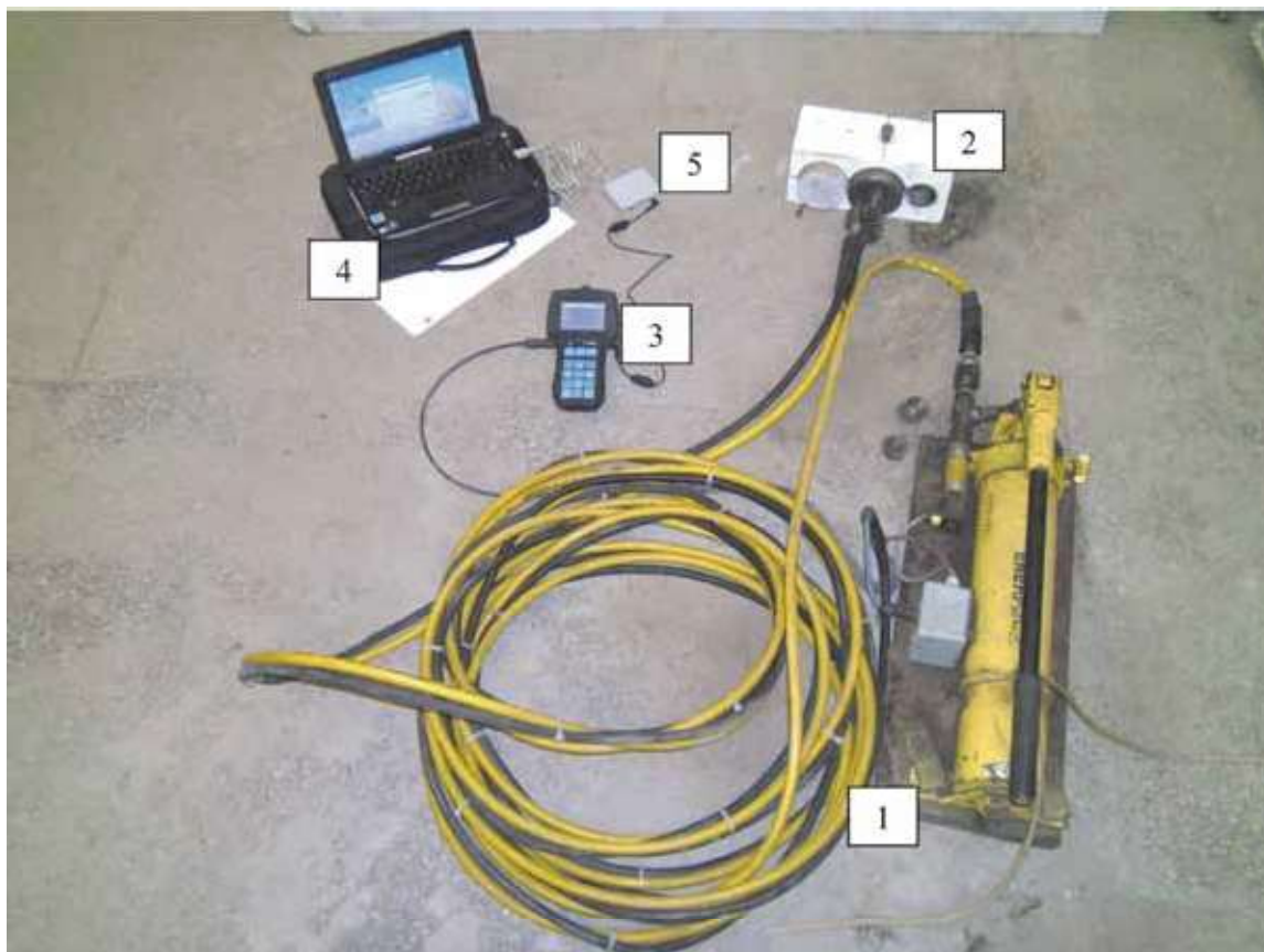
Rys. 8. Stanowisko do selekcji próbek o dużej wytrzymałości: 1 – penetrometr otworowy Pen206, 2 – blok stalowy do mocowania rdzeni, 3 – zmodyfikowany pulpit Pen206, 4 – komputer PC, 5 – przetwornik NVI_1301_02_EF Fig. 8. Laboratory stand for selection of strong rock samples: 1 – Pen206 downhole penetrometer; 2 – steel block for mounting rock cores; 3 – modified Pen206 console; 4 – PC; 5 – NVI_1301_02_EF analog to digital converter
