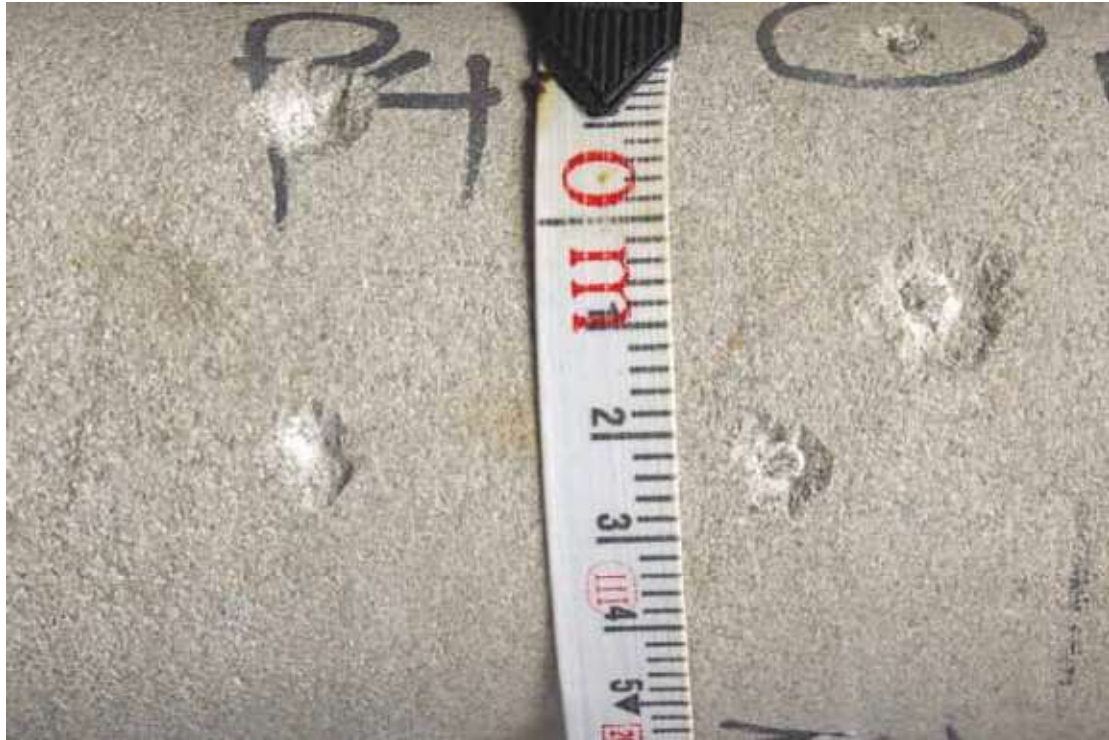
Rys. 14. Zagłębienia („kratery”) na ścianie rdzenia po działaniu naciskacza Fig. 14. Holes („craters”) on rock core’s surface caused by the penetrometer spire
