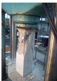
Rys. 11. Element ST3 – obraz i postać zniszczenia przy sile niszczącej N_n = 570,00 kN
