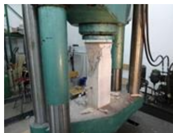
Rys. 6. Element SK2 – obraz i postać zniszczenia przy sile niszczącej N_n = 699,10 \text{ kN}
