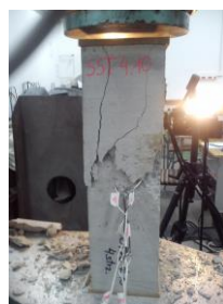
Rys. 11. Element ST3 – obraz i postać zniszczenia przy sile niszczącej N_n = 570,00 kN
