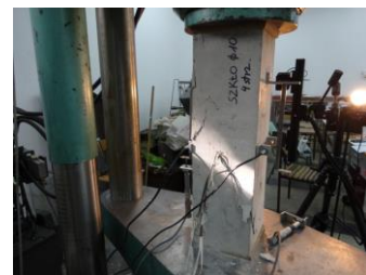
Rys. 6. Element SK2 – obraz i postać zniszczenia przy sile niszczącej N_n = 699,10 \text{ kN}
