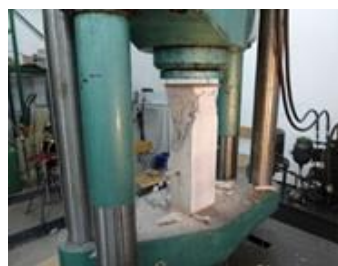
Rys. 5. Element SK1 – obraz i postać zniszczenia przy sile niszczącej N_n = 680,00 \text{ kN}
