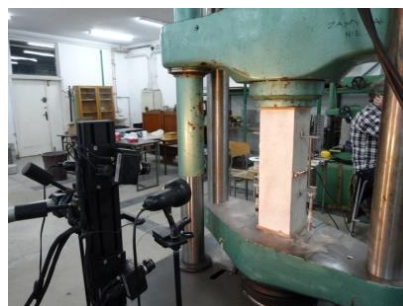
Rys. 2. Stanowisko badawcze do badania elementów ściskanych (prasa EU 1000)
