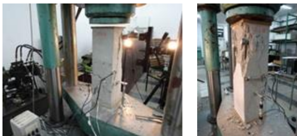
Rys. 3. Element B1 – obraz i postać zniszczenia przy sile niszczącej N_n = 550,00 \text{ kN}
