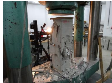
Rys. 12. Element ST4 – obraz i postać zniszczenia przy sile niszczącej N_n = 580,00 kN
