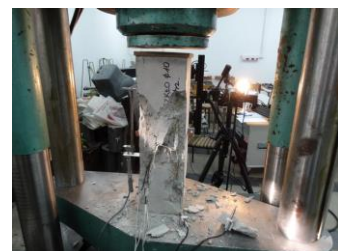
Rys. 7. Element SK3 – obraz i postać zniszczenia przy sile niszczącej N_n = 690,00 \text{ kN}
