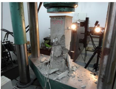
Rys. 10. Element ST2 – obraz i postać zniszczenia przy sile niszczącej N_n = 630,00 kN
