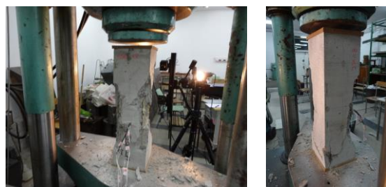
Rys. 5. Element SK1 – obraz i postać zniszczenia przy sile niszczącej N_n = 680,00 \text{ kN}
