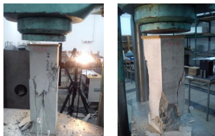
Rys. 4. Element B2 – obraz i postać zniszczenia przy sile niszczącej N_n = 727,20 \text{ kN}
