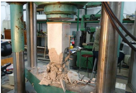
Rys. 9. Element ST1 – obraz i postać zniszczenia przy sile niszczącej N_n = 740,00 kN
