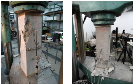
Rys. 8. Element SK4 – obraz i postać zniszczenia przy sile niszczącej N_n = 733,20 kN
