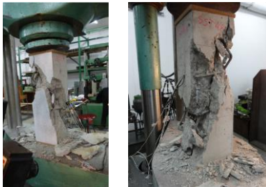
Rys. 9. Element ST1 – obraz i postać zniszczenia przy sile niszczącej N_n = 740,00 kN
