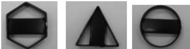
Fig. 1. Shapes of the cutters used in the study Rys. 1. Kształty wykrojników użytych do badań
