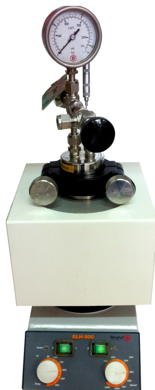
Rysunek 2 Autoklaw marki Berghof do procesu epoksydacji eteru allilowo-glicydolowego
