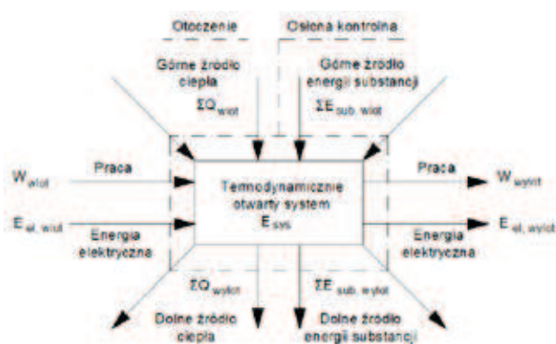
Rys. 2. Przykładowy model energetyczny dla systemu termodynamicznie otwartego [1]
