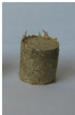
Rys. 3.2. Paliwo na bazie słomy z dodatkiem polietylenu: A – rozdrobnionego, B – nie rozdrobnionego (wyk. M. Kajda-Szcześniak).
