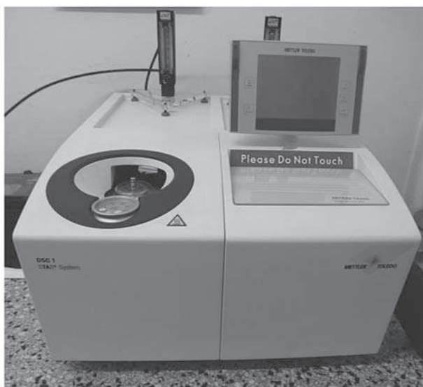
Rys. 2. Aparatura do wykonywania pomiaru metodą DSC.
