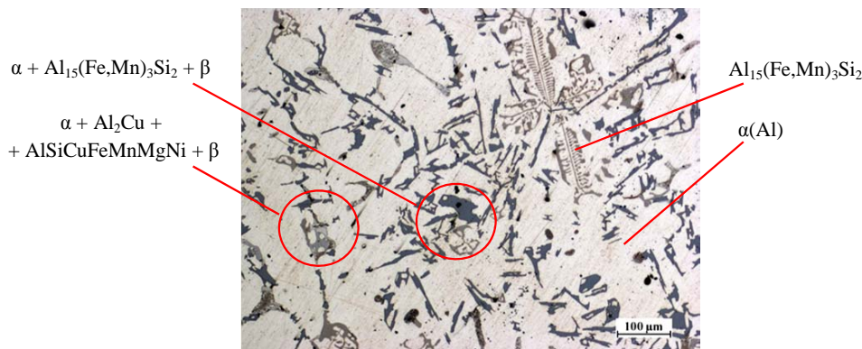
Rys. 3. Mikrostruktura siluminu wyjściowego w odlewie wykonanym w próbniku ATD: \alpha , \alpha + Al_{15}(Fe,Mn)_3Si_2 + \beta , \alpha + Al_2Cu + AlSiCuFeMnMgNi + \beta
