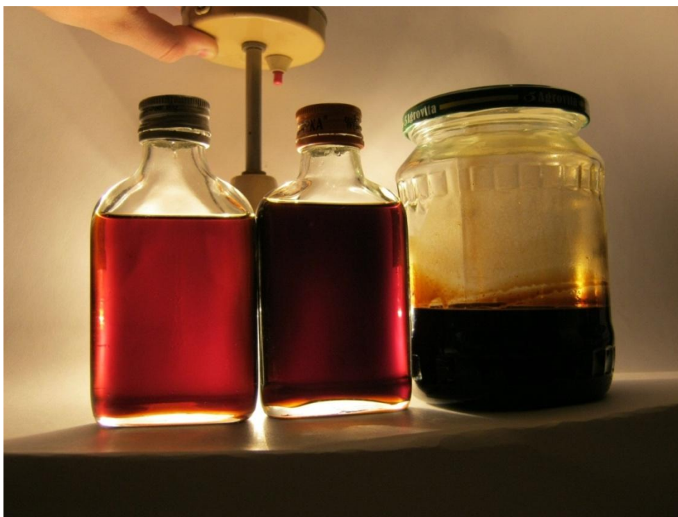
Rys. 5.1. Produkty transformacji w destylarkach oleju popirolitycznego z opon samochodowych. Od lewej: Olej pirolityczny po transformacji w destylarce, olej pirolityczny surowy, pozostałość smołowa po transformacji w destylarce oleju pirolitycznego surowego. Postać pozostałości: gęsta maź-smoła. Ilość pozostałości: 150 ml. Ilość przerobionego oleju surowego: 2,2 dm 3 . Graniczna temperatura transformacji w destylarce: 400 0 C. (fot. zbiory własne).
