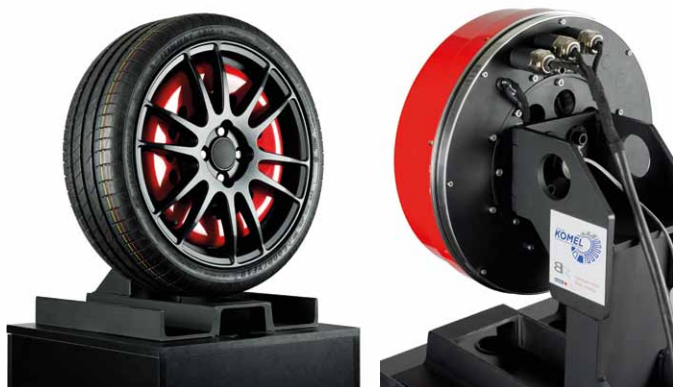
Rys. 1. Wykonany prototyp silnika do zabudowy w kole
