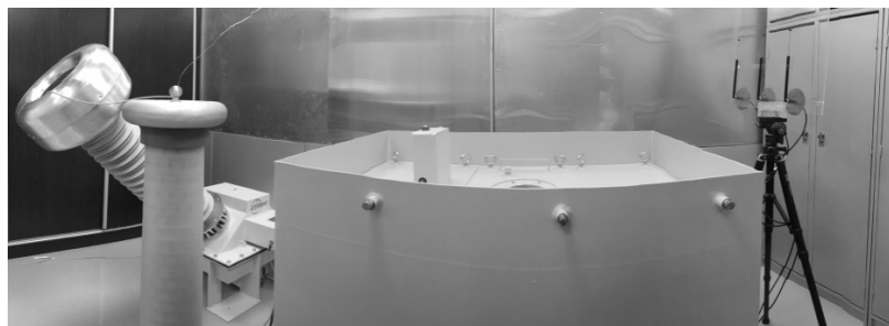
Rys. 6. Stanowisko badawcze detekcji, identyfikacji i lokalizacji wyładowań niepełnych
