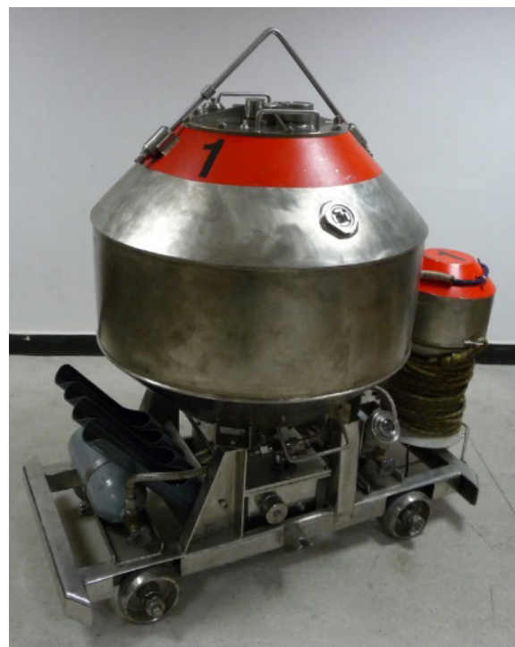
Rysunek 4 Stanowisko nr 2 – MMDP z wózkiem i komorą przyrządów
