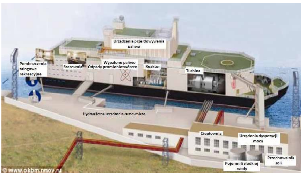
Fot. 3. Projekt pływającej elektrowni jądrowej z urządzeniami nadbrzeżnymi według OKBM Afrikantow i Instytutu Badań i Rozwoju Atomenergoproekt z Niżnego Nowogrodu z dwoma reaktorami KLT-40S budowanej w stoczni w Petersburgu jako „Akademik Łomonosow” (fot. okbm.nnov.ru)
