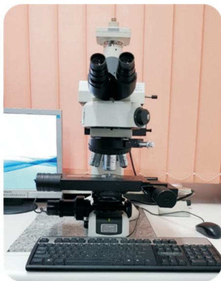
Rys. 1. Mikroskop optyczny NIKON ECLIPSE LV100 D współpracujący z komputerem PC
