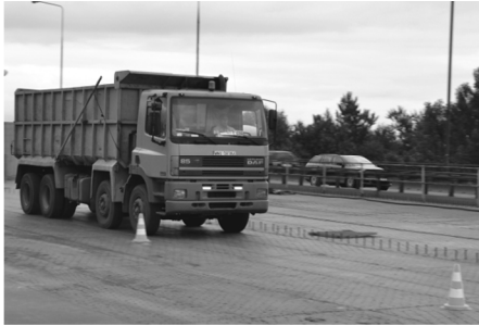
Rys. 2. Samochód ciężarowy wykorzystywany do wzbudzenia drgań mostu
