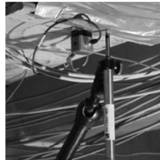
Rys. 6. Trójosiowy czujnik przyspieszeń zamocowany na dolnej półce żebra
