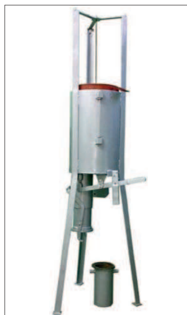
Rys. 6. Urządzenie do oznaczania przewiewności mieszanki
