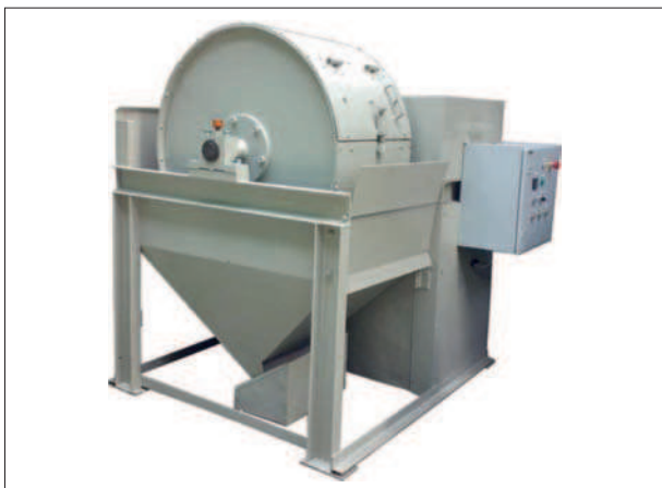
Rys. 11. Bęben do oznaczania wytrzymałości spieku metodą ISO
