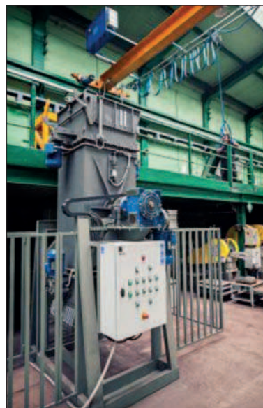
Rys. 10. Urządzenie zrzutowe do oceny wytrzymałości spieku
