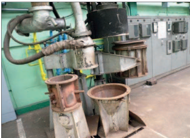
Rys. 7a. Stanowisko spiekania przed ostatnią modernizacją
