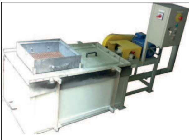
Rys. 13. Laboratoryjny przesiewacz z mechanicznym wzbudzeniem drgań do rozsiewania spieków
