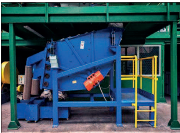
Rys. 12. Elektrowibracyjny przesiewacz pięciopokładowy do rozsiewania spieków wielkopieczowych
