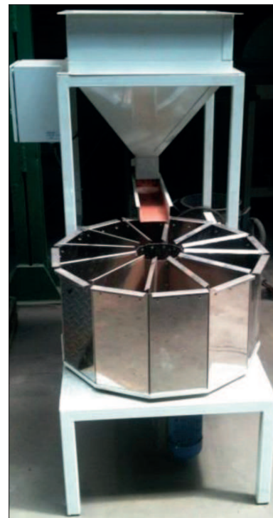
Rys. 2. Obrotowy rozdzielacz próbek do uśredniania materiałów
