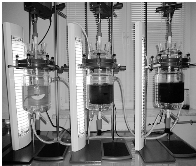
Rys. 1. Stanowisko laboratoryjne do prowadzenia hodowli alg
