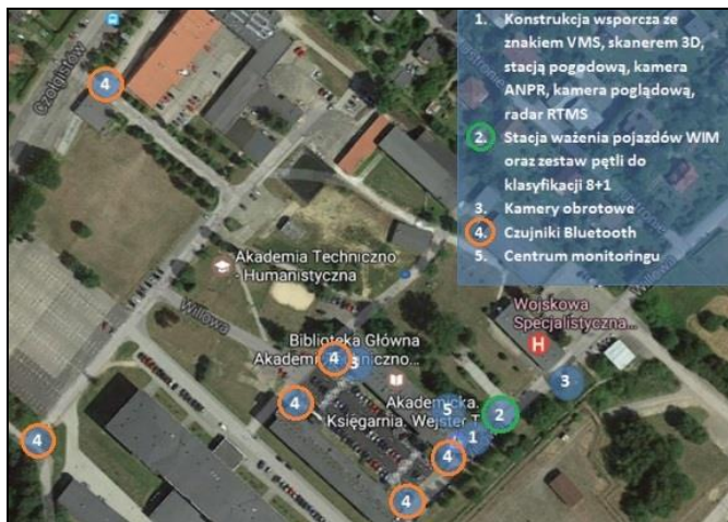
Rys. 2. Polygon ITS – rozmieszczenie przestrzenne komponentów[5]
