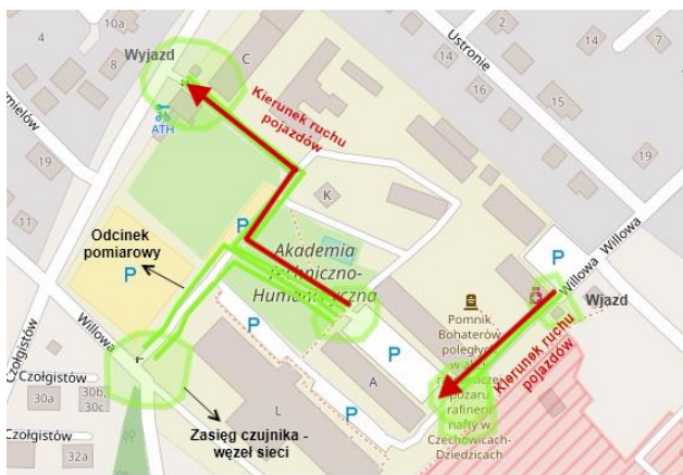
Rys. 3. Architektura systemu detekcji Bluetooth wraz z organizacją ruchu pojazdów
