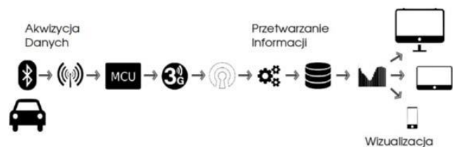
Rys. 1. Schemat funkcjonowania systemu detekcji Bluetooth [4]
