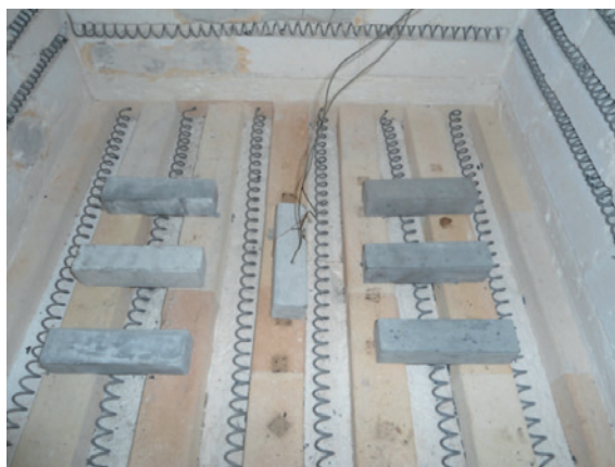
Rycina 4. Próbkę prostokątne w komorze pieca (gdzie: 3 próbki bez dodatku włókien; 1 próbka do pomiaru rozkładu temperatury; 3 próbki z dodatkiem włókien PP)
