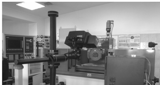
Rys. 3. Triangulacyjny skaner ATOS III SO (Small Object) na stanowisku laboratoryjnym
