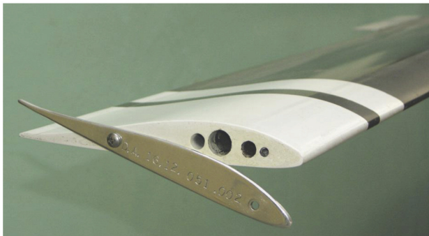
Rys. 6. Zakończenie łopaty laminatowej demonstratora I-28 A [Aut., 2013]
