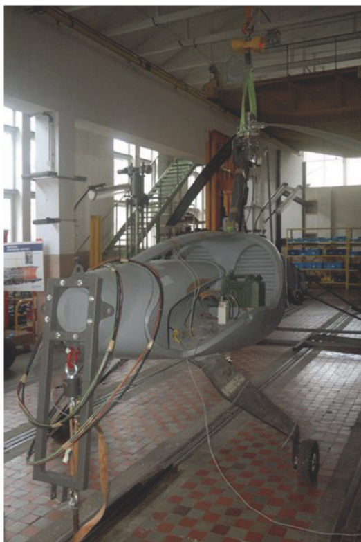
Rys. 7. Skalowanie układu do pomiaru impulsu ciągu wirnika [Aut., 2013]
