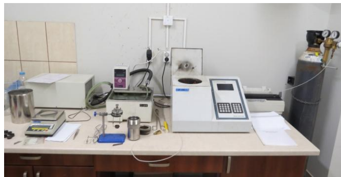
Fot. 3. Stanowisko do badań ciepła spalania wg normy PN-EN ISO 1716 w Laboratorium Badań Ogniwych Instytutu Techniki Budowlanej w Pionkach; Archiwum ITB
