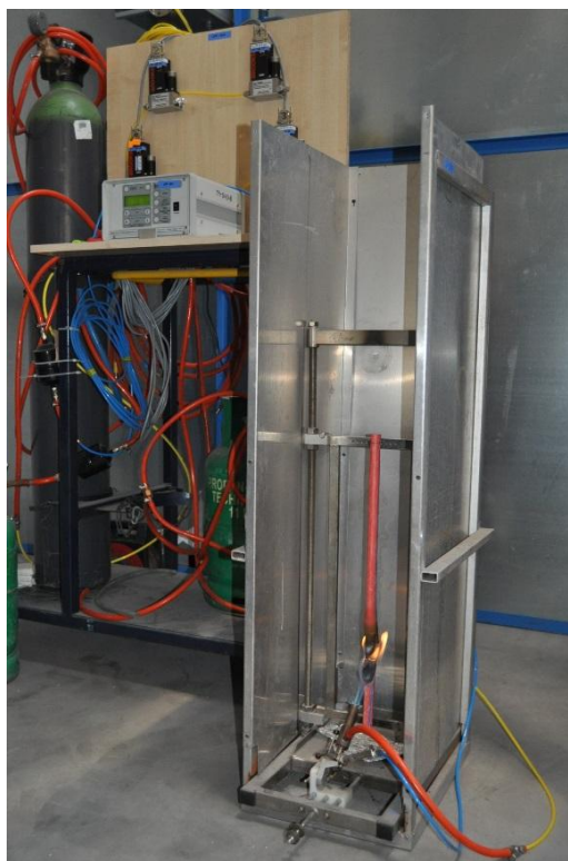
Fot. 2. Stanowisko do badania reakcji na ogień kabli elektroenergetycznych wg normy PN-EN 60332-1-2 w Laboratorium Badań Ogniwych Instytutu Techniki Budowlanej w Pionkach; Archiwum ITB
