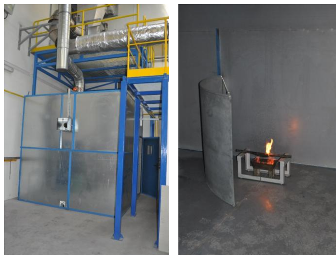
Fot. 4. Komora do badań gęstości dymu powstałego podczas badania kabli wg normy PN-EN 61034-2; Archiwum ITB
