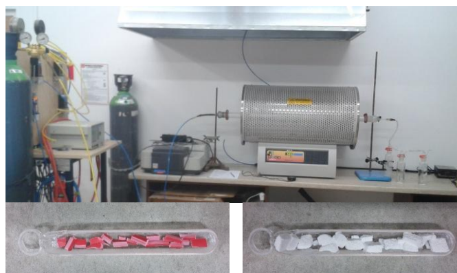
Fot. 5. Stanowisko do badania kwasowości/konduktywności gazów powstałych podczas spalania kabli wg PN-EN 60754-2 (d. PN-EN 50267-1-2-(2, 3)) w Laboratorium Badań Ogniwych Instytutu Techniki Budowlanej w Pionkach oraz kwarcowa tódka do spalań z rozdrobioną próbką powłoki zewnętrznej kabla przed i po badaniu; Archiwum ITB
