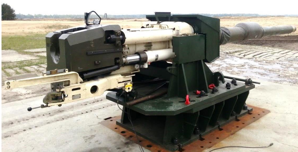
Fot. 1. Stanowisko Leopard zamocowane na płycie stanowiska ogniowego
