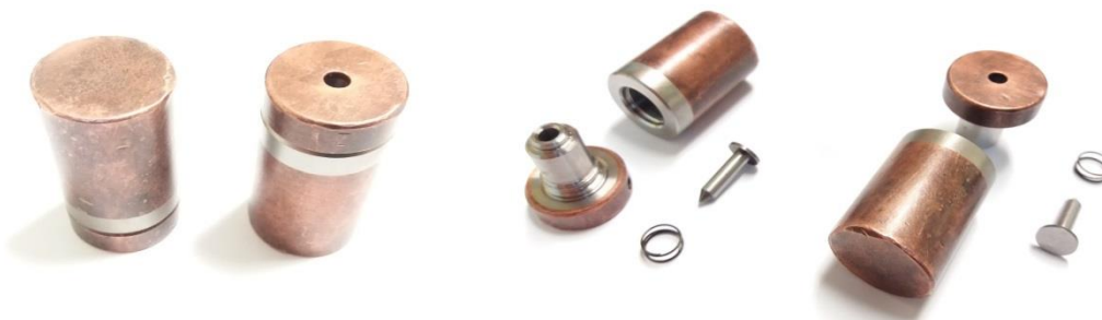
Fot. 5. Przyrządy zgniotowe o objętości 13,7 \text{ cm}^3 i średnicy tłoczka 3,91 \text{ mm} zmontowane i po demontażu
