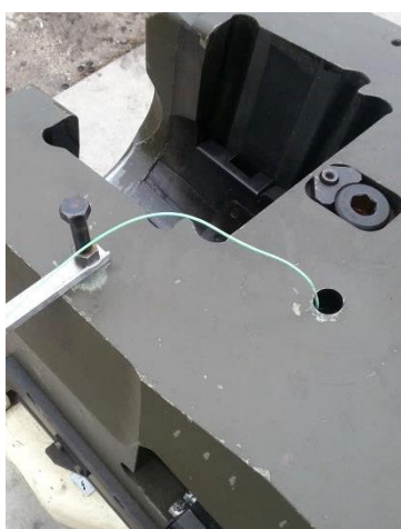
Fot. 7. Czujnik piezoelektryczny wkręcony w gniazdo ścianki komory naboju od strony nasady z bocznie odprowadzonym przewodem sygnałowym
