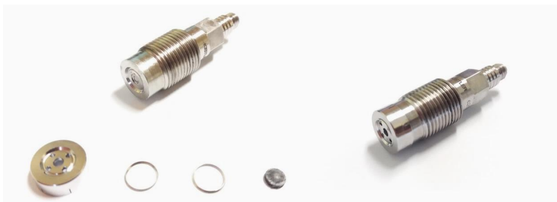
Fot. 6. Czujnik piezoelektryczny przed i po zamocowaniu części ochronnych Photo 6. Piezoelectric sensor before and after fixing the protective parts
