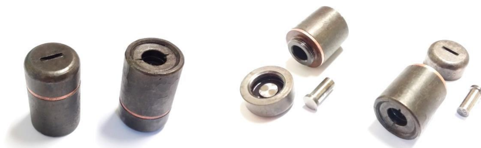
Fot. 3. Przyrządy zgniotowe o objętości 7 \text{ cm}^3 zmontowane i po demontażu Photo 3. Assembled and disassembled crushing devices of 7 \text{ cm}^3 capacity
