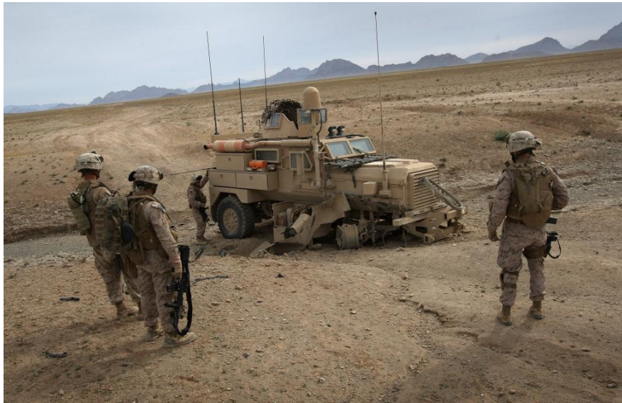
Rys. 2. Zniszczony pojazd opancerzony, który wjechał na improwizowaną minę
