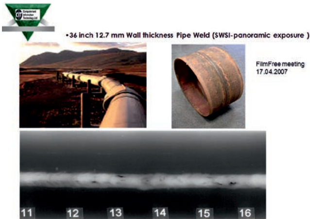
Fig. 1. Inspection of welded pipelines with CR [6] Rys. 1. Inspekcja rurociągów za pomocą radiografii cyfrowej [6]
