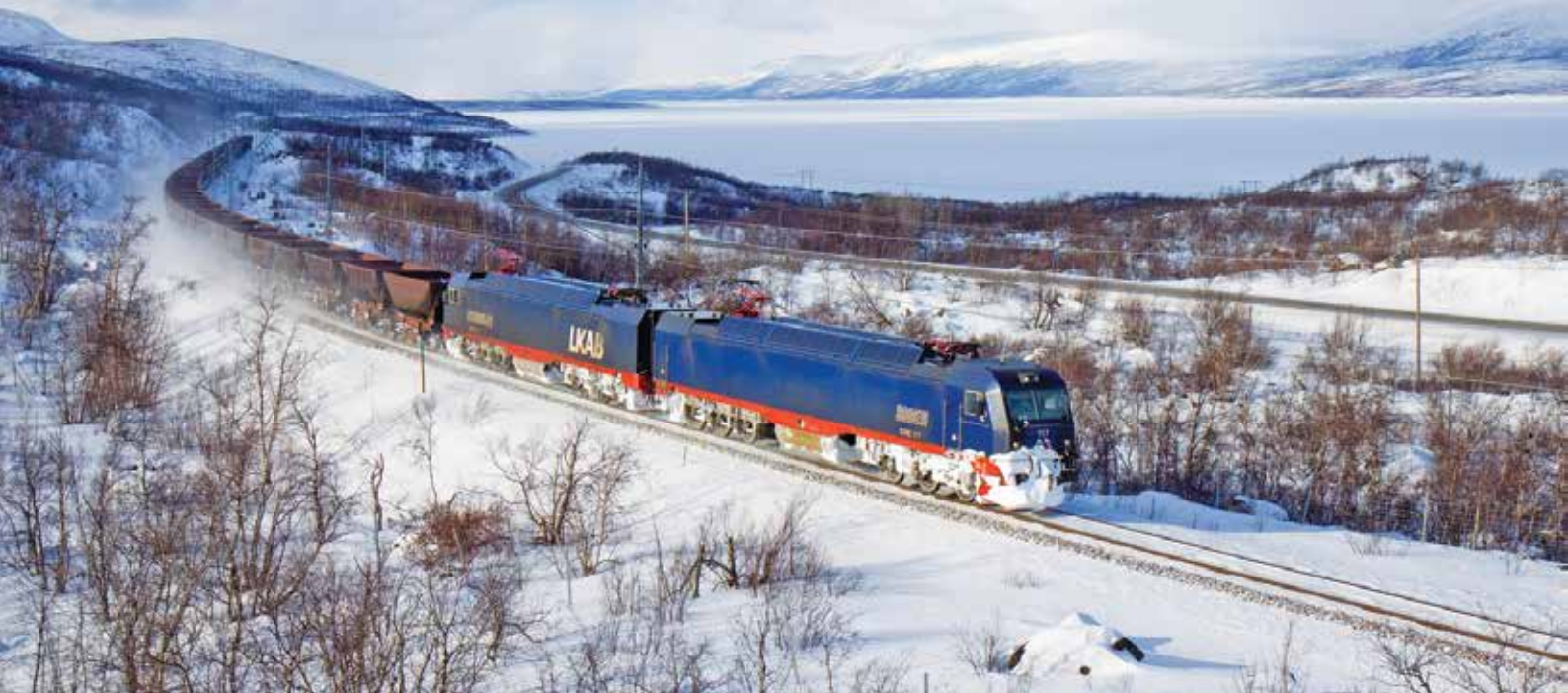
Lokomotywa serii IORE 117+116 (15 kV 16,7 Hz) przewoźnika MTAB z pustym pociągim towarowym w pobliżu jeziora Torneträsk, pomiędzy stacjami Abisko i Kiruna, Szwecja (18.03.2009 r.) fot. Kabelleger / D. Gubl / Wikimedia Commons
