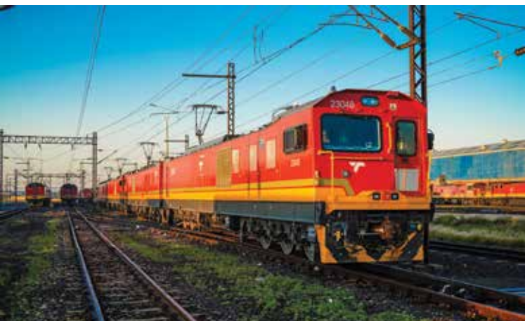
Lokomotywa serii 23E / 23048 (3 kV DC, 25 kV 50 Hz; 1067 mm) przewoźnika Transnet Freight Rail, Pld. Afryka fot. Bombardier
