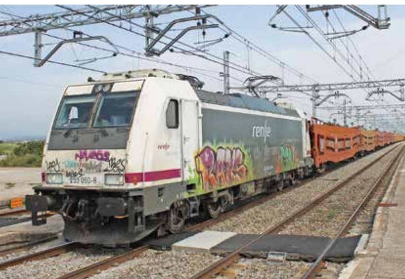
Traxx F140DC serii 253.060 (3 kV DC, 1668 mm) przewoźnika Renfe z poc. towarowym na stacji Vilamalla, Hiszpania (2.08.2011 r.) fot. J. Verdugo / Wikimedia Commons
