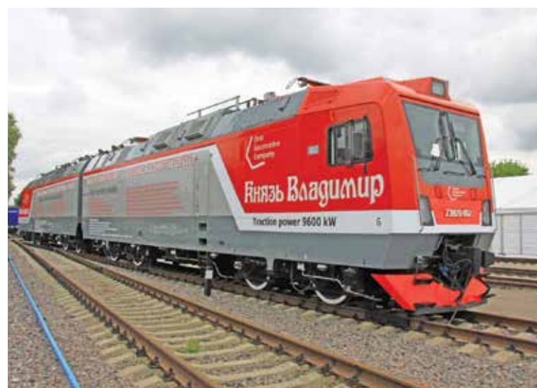
Traxx RUS, czyli lokomotywa serii 2EW120 (3 kV DC, 25 kV 50 Hz; 1520 mm) wyprodukowana we współpracy z Bombardierem dla RЖД, Szczerbinka k. Moskwy (5.09.2015 r.). fot. D. Szczukin
