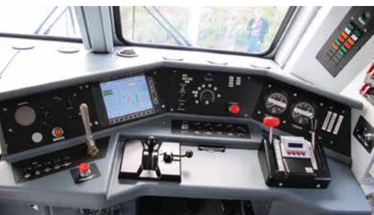
Pulpit sterowania lokomotywy spalinowo-elektrycznej serii ALP-45DP-1356 przewoźnika NJT (21.09.2010 r.) fot. bengt / Wikimedia Commons
