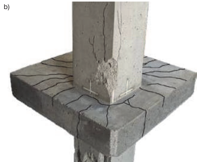
Rys. 10. Modele serii MN po zniszczeniu: a) element z płytą zlicowaną, b) element z płytą przewieszoną poza krawędzie słupa
