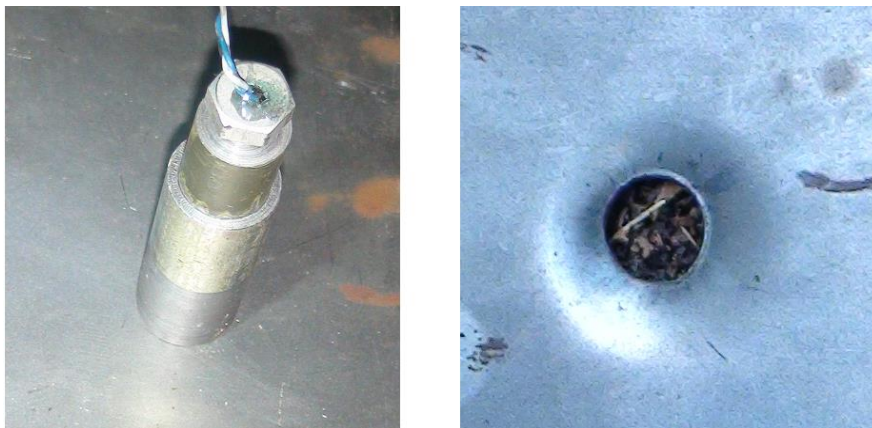
Rys. 12. Test nowego układu inicjowania detonacji na stalowej płycie Figure 12. Testing the new detonation initiating system on the steel plate
