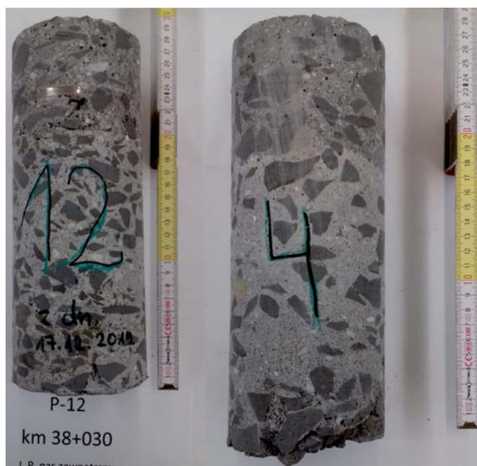
Fot. 5. Przykłady pobranych walcowych próbek nawierzchni droga krajowa nr 18 [7]
