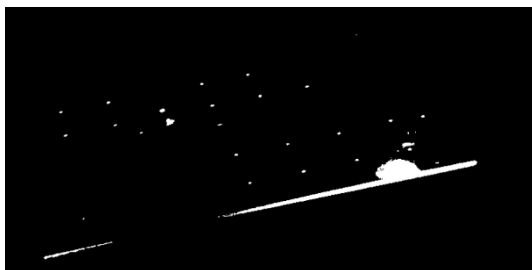
Rys. 5. Odbicia światła błędnie rozpoznawane jako markery RB Fig. 5. Light reflections which are recognised as „false” Rigid Body markers
