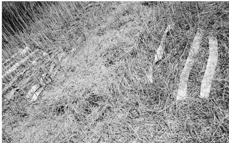
Rys. 3. Obraz taśm pomiarowych po zbiorze nasion rzepaku kombajnem bez zastosowania rozdrabniacza słomy Fig. 3. View of measuring belts after rape seeds harvesting without of straw cutter using
