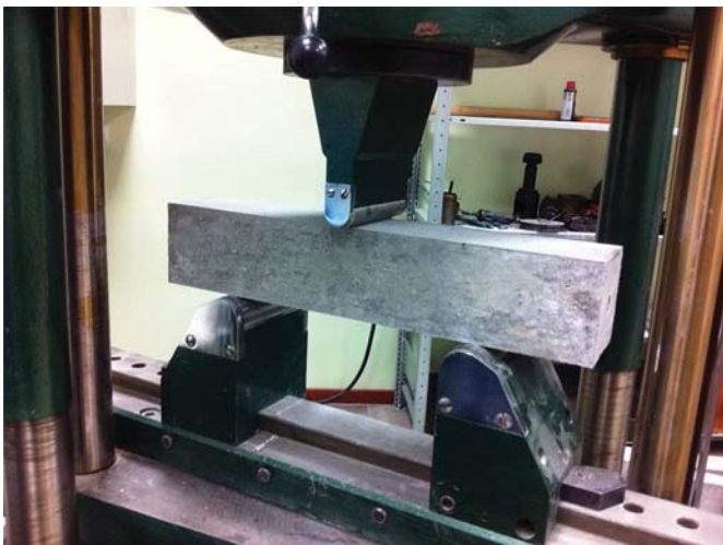
Fot. 6. Belka betonu wałowanego podczas badania wytrzymałości na zginanie
