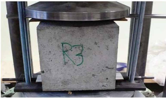
Fot. 5. Przebieg badania wytrzymałości na rozciąganie przy rozłupywaniu
