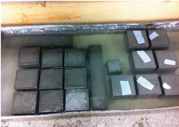
Fot. 4. Wykonane próbki betonowe
