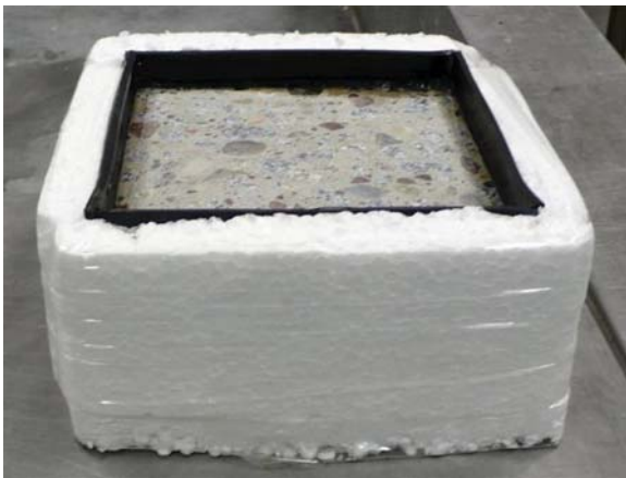
Fot. 7. Przygotowana próbka betonowa przed zalaniem medium badawczym
