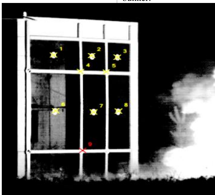
Fot. 3. Widok elewacji w trakcie wybuchu
