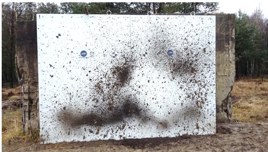
Fot. 8. Fasada po próbie - I etap
