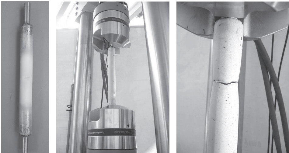
Rys. 1. Wycinek rury przygotowany do obciążenia siłą osiową.
