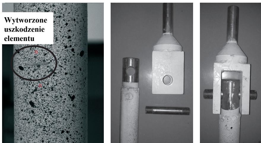
Rys. 3. Wycinek rury przygotowany do obciążenia siłą osiową.
