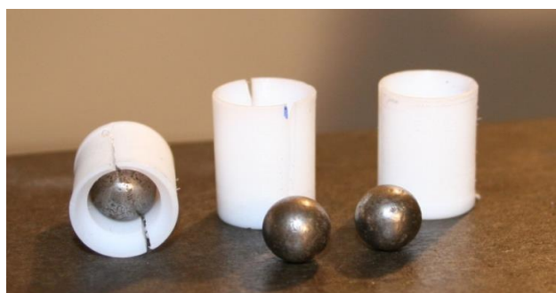
Rys. 3. Stalowe kulki o średnicy 8mm i teflonowe saboty
