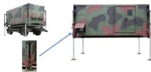
Rys.13. Załadunek systemem opartym o 4 sterowane podpory hydrauliczne. Źródło: [4].
