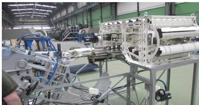
Rys. 2. Zespół magazynu amunicyjnego 120 mm Moździerzka samobieżnego RAK. Źródło: [3]
