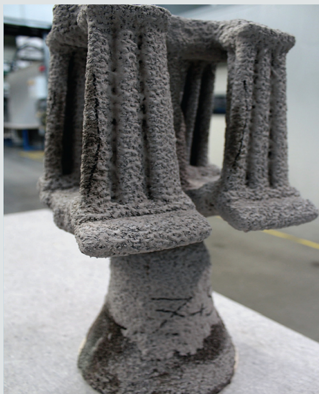
Fot. 1. Pęknięcie formy odlewniczej
