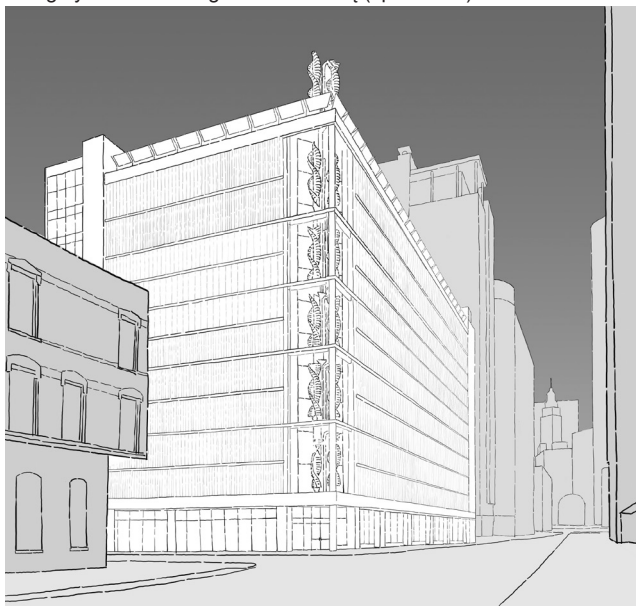
Rys. 7. Greenway Self Park, HOK, Chicago, 2009: turbiny wiatrowe o poziomej osi obrotu zintegrowane z budynkiem (oprac. aut.)
