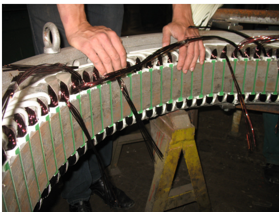
Rys. 4. Widok stojana generatora podczas przezwojenia
