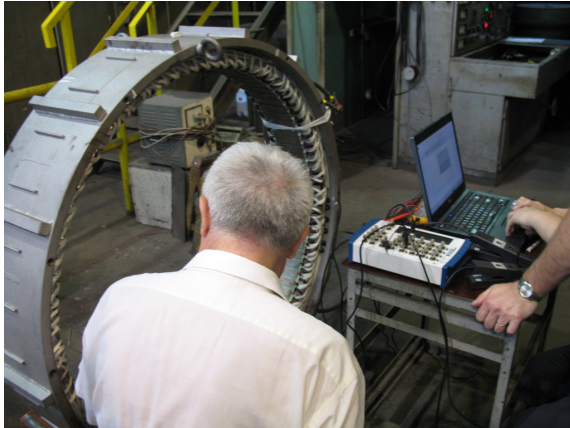
Rys. 7. Zestawiony układ pomiarowy do rejestracji sygnałów diagnostycznych
