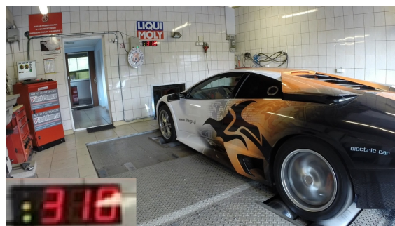
Rys. 13. Prototyp elektrycznego samochodu SMOK na hamowni pojazdowej
