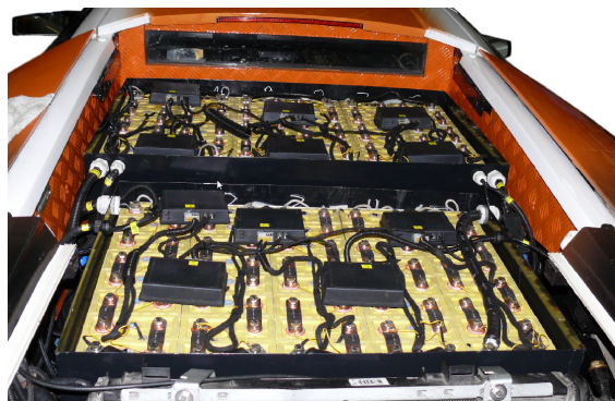
Rys. 8. Widok pakietu akumulatorów LiFePO4 z systemem BMS
