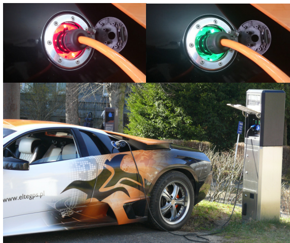
Rys. 10. Samochód SMOK podczas ładowania pakietu akumulatorów
