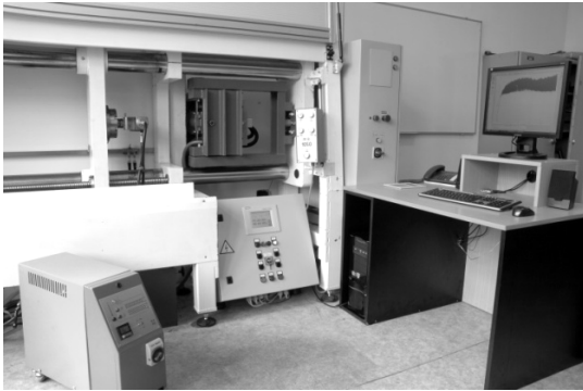
Fig. 2. Equipment „SOKOL 400“ for tribological testing and principle of test Rys. 2. Urządzenie do testu „SOKOL 400“ i zasady badania tribologicznego
