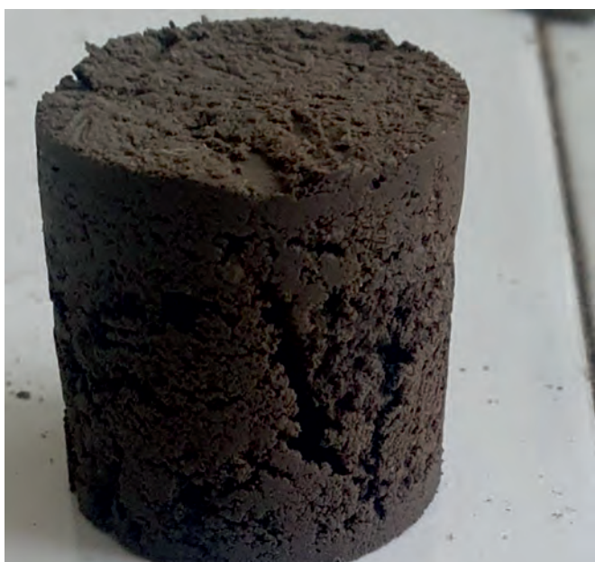
Fig.5 Soil from borehole S-2 collected with a bulk density ring Rys.5 Grunt z otworu S-2 pobrany za pomocą pierścienia do badania gęstości objętościowej
