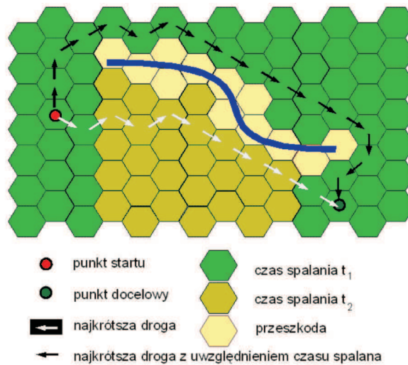
Rys. 8. Porównanie najkrótszej i najszybszej drogi pożaru w zróżnicowanym środowisku rozprzestrzeniania ognia Źródło: opracowanie własne.
