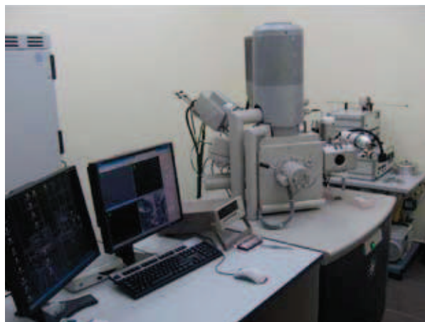
Rys. 7. Wysokorozdzielczy elektronowy mikroskop skaningowy FEI Nova NanoSEM 230 z mikroanalizatorem rentgenowskim EDS [opracowano na podstawie 21]
