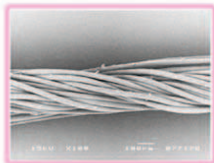
Rys. 2. Struktura przędzy filtracyjnej skręconej – widok wzdłużny [opracowanie własne]
