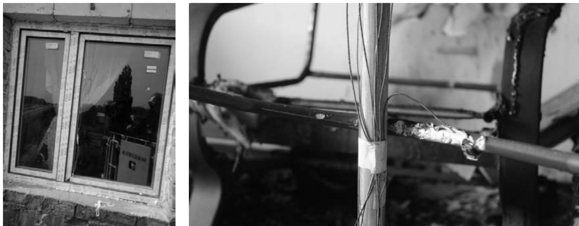
Ryc. 5. Przykład umieszczenia drzewa termopar. Wzdłuż okna PVC na zewnątrz oraz przy spalonym fotelu po wykonanym teście pożarowym
