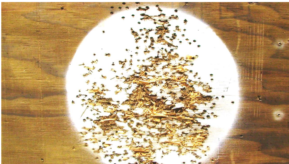
Fot. 3. Kulochwyt specjalny po ostrzale amunicją 5,56 mm w liczbie 1500 szt.[4]
